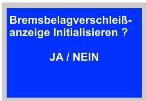
Die Initialisierung erfolgt im Fahrgestellelektronik Steuergerät unter dem Punk **BBVA Reset**.
